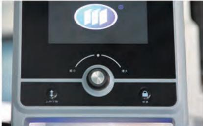
Durch unser Patent zum positionsgenauen Anheben und Absenken des Schleifkopfes wird die Sicherheit erhöht und es entfällt das manuelle Feststellen in einer Schleifposition
