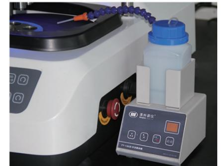
Optional können alle Maschinen mit einer Dosiereinheit ausgestattet werden
