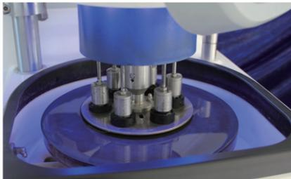
Im Einzelandruck können bis zu 6 Proben gleichzeitig angedrückt werden.
